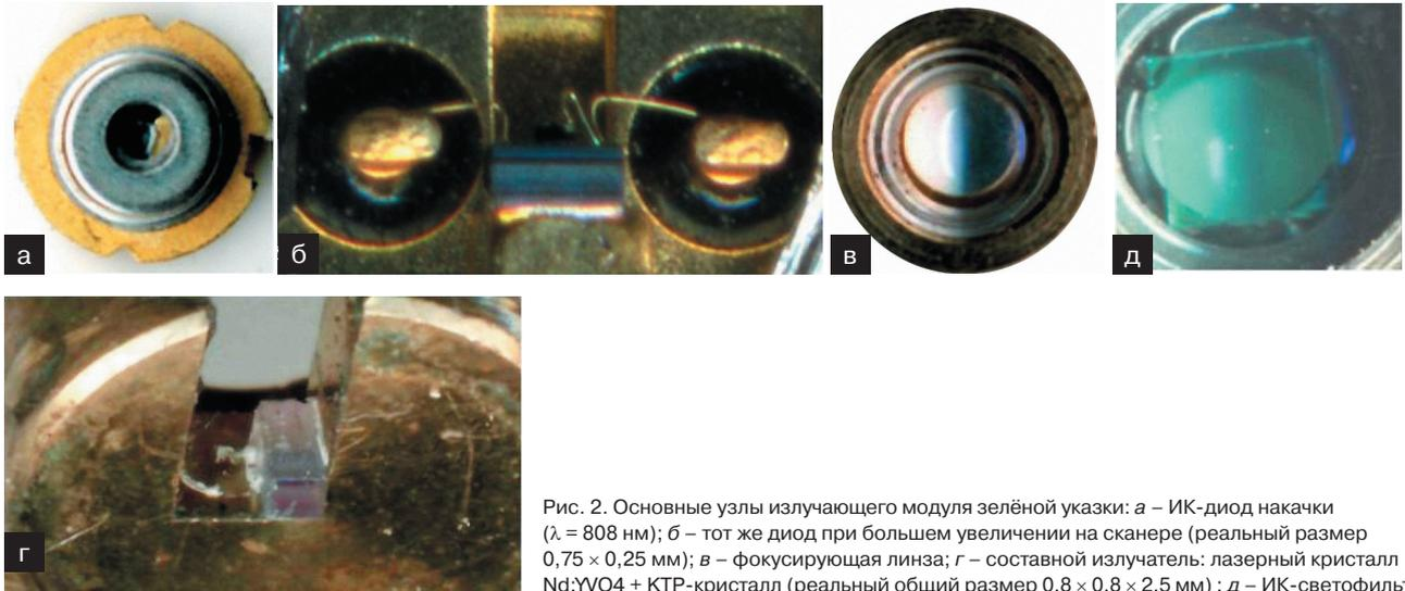
Рис. 2. Основные узлы излучающего модуля зелёной указки: а – ИК-диод накачки ( $\lambda = 808$  нм); б – тот же диод при большем увеличении на сканере (реальный размер  $0,75 \times 0,25$  мм); в – фокусирующая линза; г – составной излучатель: лазерный кристалл  $\text{Nd:YVO}_4$  + КТР-кристалл (реальный общий размер  $0,8 \times 0,8 \times 2,5$  мм); д – ИК-светофильтр
