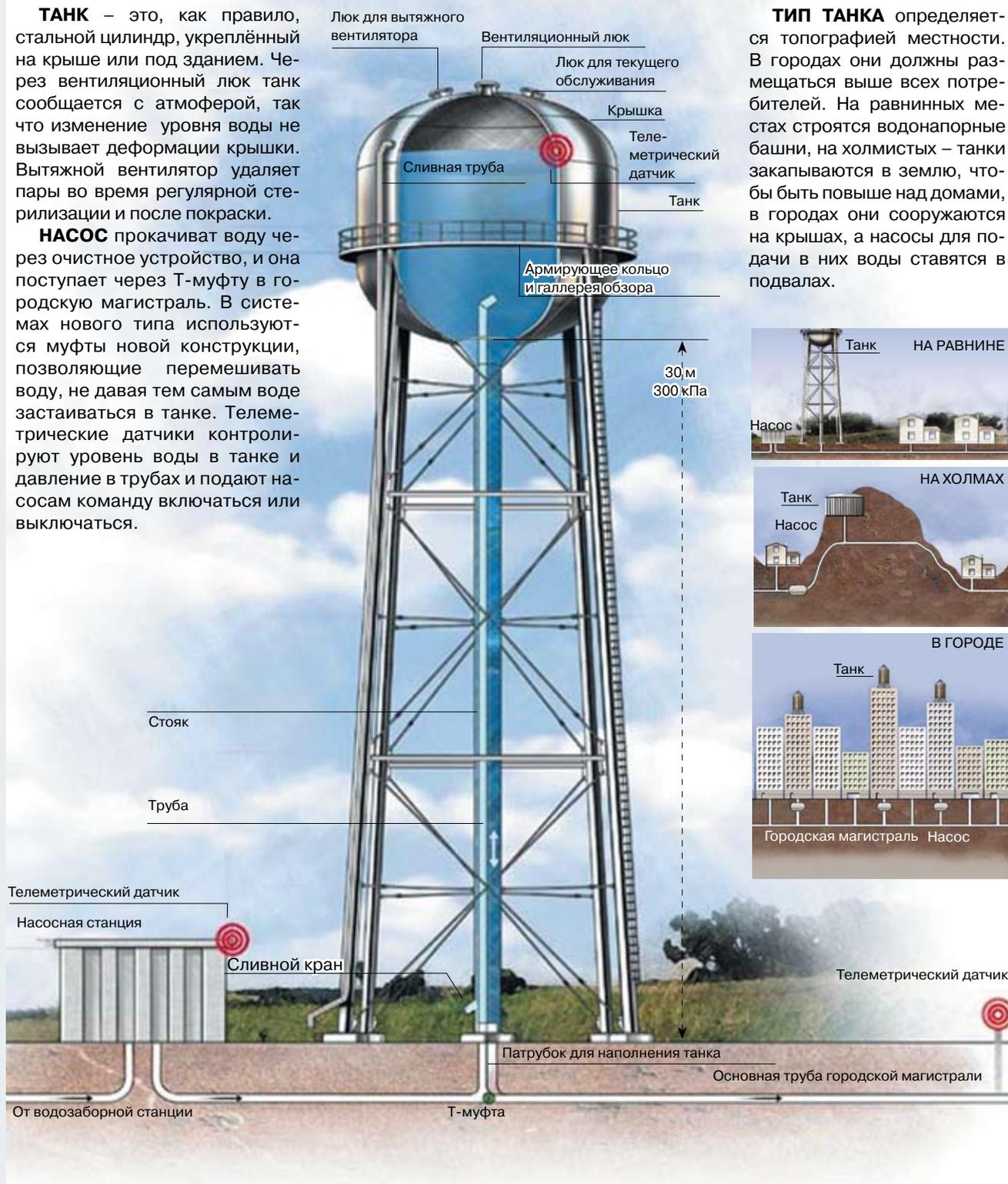
**ТИП ТАНКА** определяется топографией местности. В городах они должны размещаться выше всех потребителей. На равнинных местах строятся водонапорные башни, на холмистых – танки закапываются в землю, чтобы быть повыше над домами, в городах они сооружаются на крышах, а насосы для подачи в них воды ставятся в подвалах.
