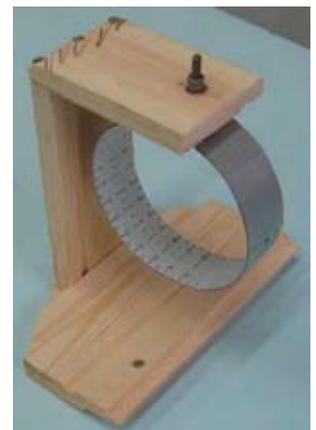
ложных сторонах вдоль центральной линии. Наклеили на одну сторону миллиметровую бумагу и отметили цифрами точки через каждые 3–4 мм. Согнули эту пластинку в кольцо, чтобы миллиметровая бумага оказалась внутри, и болтом через отверстие закрепили его в стойке. В кольце просверлили напротив шкалы с цифрами очень маленькое отверстие для солнечного луча.
