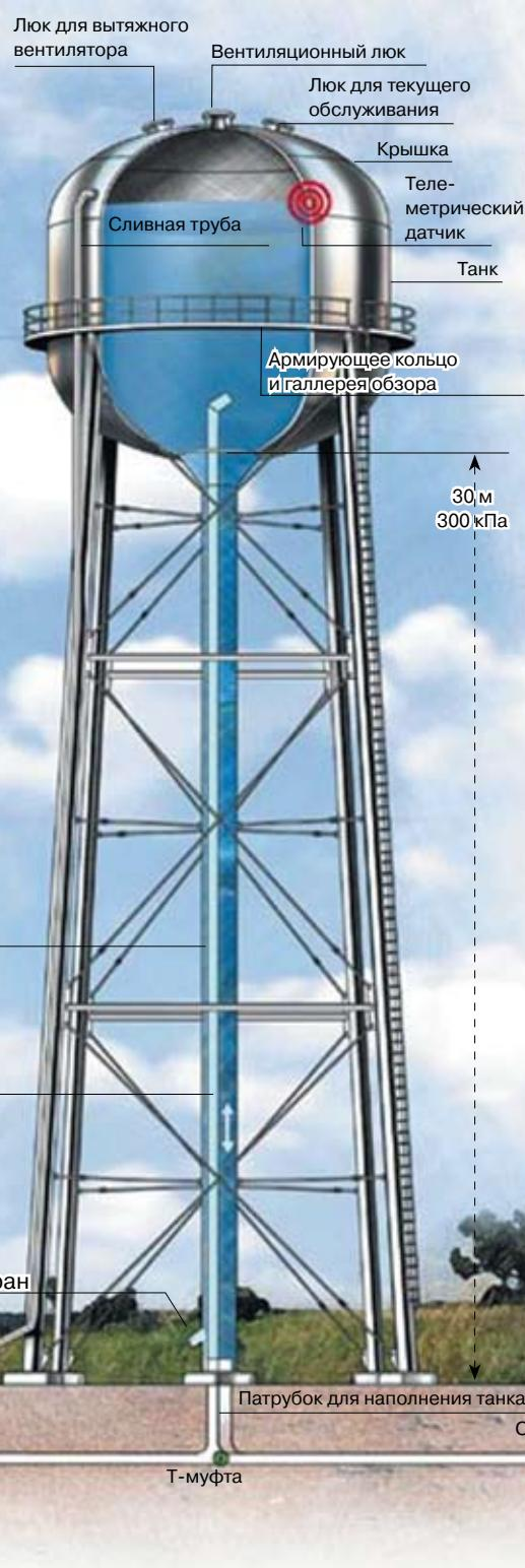
**ТИП ТАНКА** определяется топографией местности. В городах они должны размещаться выше всех потребителей. На равнинных местах строятся водонапорные башни, на холмистых – танки закапываются в землю, чтобы быть выше над домами, в городах они сооружаются на крышах, а насосы для подачи в них воды ставятся в подвалах.
