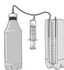
объём воздуха в шприце на 5 мл, определяйте изменение показаний манометра  $\Delta h$  • результаты измерений представьте в виде таблицы:
