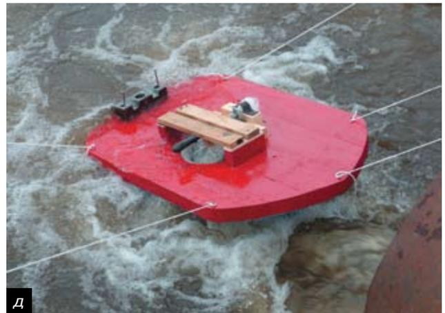
Рис. 2. Постройка и испытание модели: а – тканевая турбина; б – днище платформы с отверстием под циклонную камеру и деревянные элементы этой камеры; в – гидроэлектропривод со светящимся светодиодом; г – Митя Шестериков готовится к натурным испытаниям; д – модель гидроэлектростанции на испытаниях.
