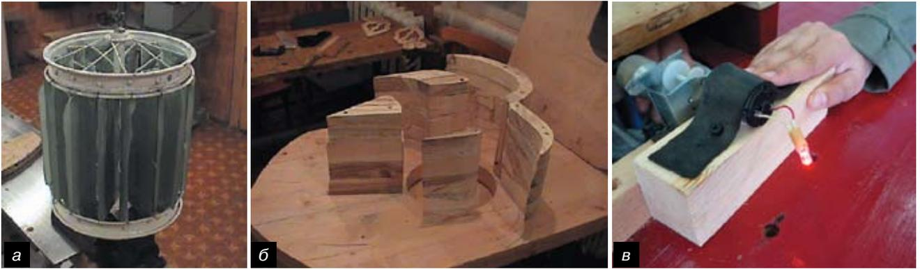
нитью крепились лопасти, изготовленные из прочной корсажной синтетической ленты шириной 50 мм. Связки для прочности заливались лаком. Тканевые полоски крепились внахлёт, что создавало сплошную тканевую лопасть при прямом попадании на неё потока воды. При возникновении бокового или обратного избыточного давления отдельные полосы могли расходиться и создавать, по сути, перепускной клапан.
