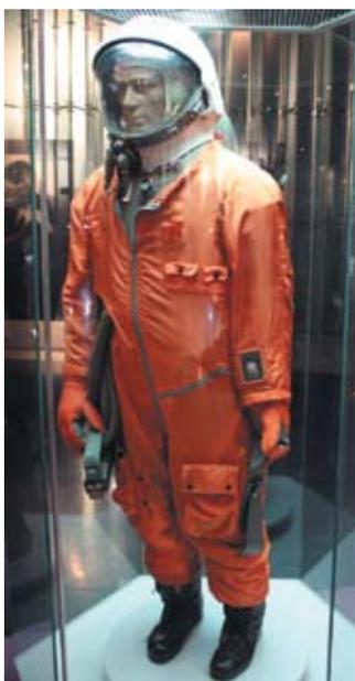
Скафандр «СК-1» мягкой конструкции с вентиляционной системой открытого типа. Предназначался для космонавтов кораблей «Восток». Применялся при всех полётах космонавтов на кораблях «Восток» до 1963 г. Масса 20 кг. Разработан на заводе «Звезда» в 1960–61 гг. (galspace.spb.ru)
