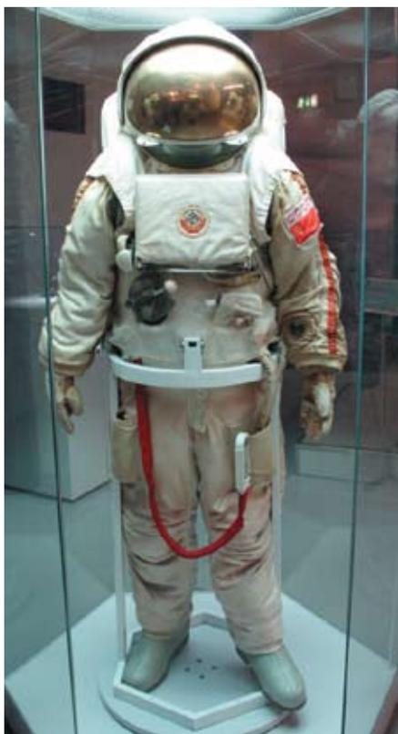
Скафандр «Кречет» для выхода в открытый космос и работы космонавта-исследователя на поверхности Луны. Подлинник. Скафандр полужёсткого типа со встроенной системой жизнеобеспечения. Изготовлен на заводе «Звезда» во второй половине 1960-х гг. для программы Н1-ЛЗ (galspace.spb.ru)
