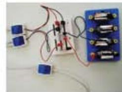
Рис. 4. Изучение закона Ома с помощью модулей напряжения и силы тока
