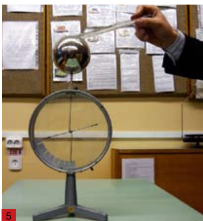
5 Зарядим электроскоп положительно стеклянной палочкой.
