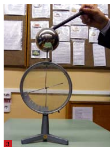
3 Зарядим электроскоп отрицательно эбонитовой палочкой.
