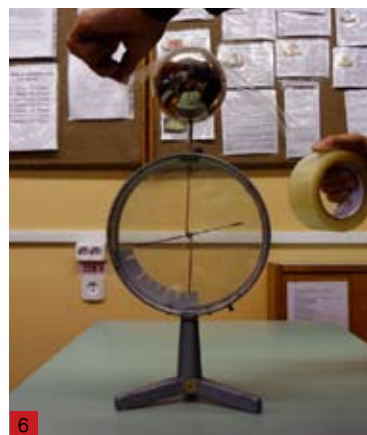
6 Коснёмся электроскопа оторванной лентой: он не разрядится.
