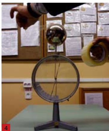
4 Коснёмся электроскопа оторванной лентой: он разрядится.
