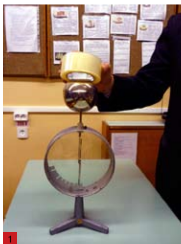
1 Проверим, заряжена ли изначально лента-скотч.
