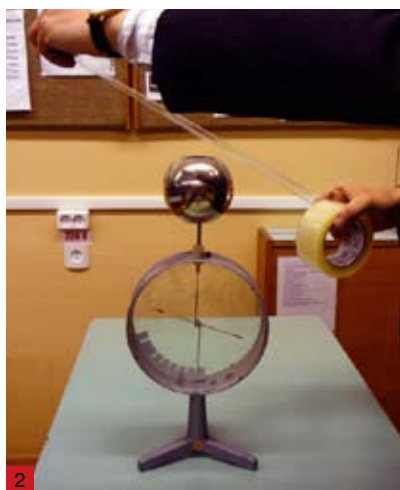
2 Резко оторвём ленту от катушки: стрелка электроскопа отклонится.
