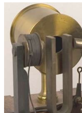
Аппарат Гельмгольца для синтеза звука с помощью резонатора оригинальной конструкции и камертона
