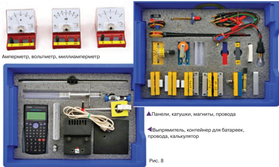
Амперметр, вольтметр, миллиамперметр
