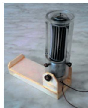
Для объяснения принципов действия агрегатов гидроэлектростанции учащиеся лицея № 5 А. Сагадеева и К. Вдовин сконструировали и изготовили действующую модель турбины и электрогенератора, которые можно демонстрировать с помощью графопроектора как отдельными частями, так и в их взаимодействии.
