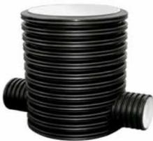
Выполняются по эскизу заказчика на участке нестандартных изделий КТЗ с указанием диаметра и типа входных/выходных труб, их количества и положения, наклона патрубков и их высоты по отношению к телу колодца. При этом само тело колодца может быть любого диаметра в диапазоне от 400 до 2000 мм и высоты, дно - лотковым (для
