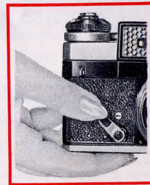
Рис. 17. Взвод рычага автоспуска
