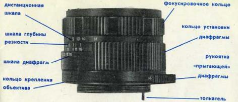
«Прыгающая» диафрагма работает в автоматическом режиме, если ее рукоятка стоит на индексе «А». Это дает возможность фокусировать изображение при максимальном отверстии диафрагмы. При нажатии спусковой кнопки затвора автоматически происходит установка предварительно заданного относительного отверстия.
