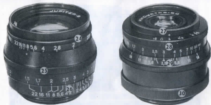
Рис. 4. Объективы «Юпитер-8» и «Индустар-50». 24—кольцо со шкалой диафрагм; 25—фокусировочное кольцо со шкалой расстояний и индексом шкалы диафрагм; 26—шкала глубины резкости; 27—кольцо установки диафрагмы с индексом; 28—фокусировочное кольцо со шкалой диафрагм и шкалой расстояний; 29—шкала глубины резкости; 30—кольцо крепления объектива
