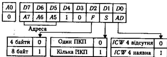
Рис. 5.58. Формат керуючого слова ініціалізації ICW1
