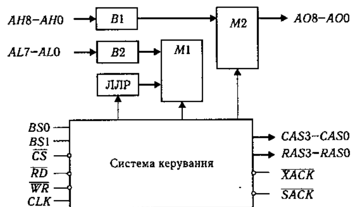
Рис. 4.7. Структурна схема контролера динамічної пам'яті i8207
